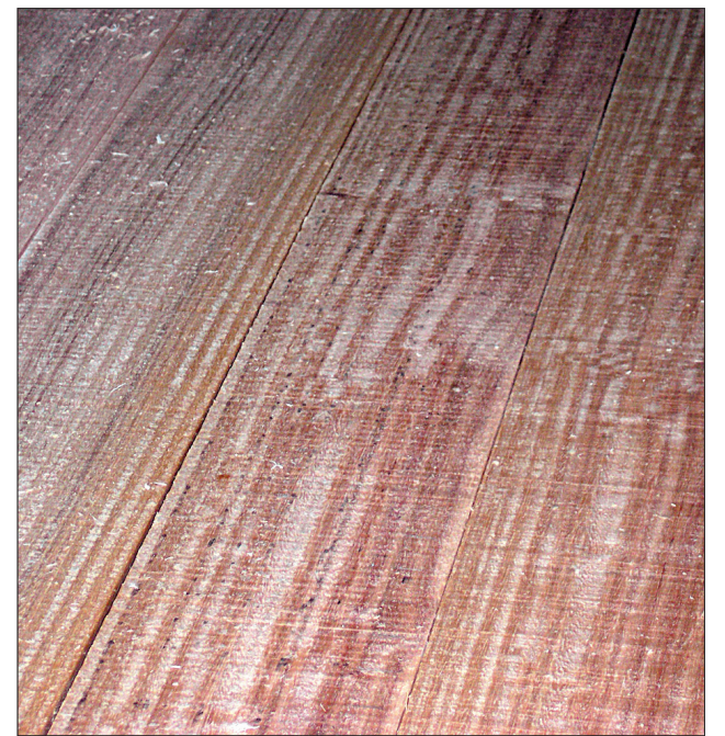
Abbildung 4 Erzeugte Bretter aus dem mittleren Kernbereich: Rifts und Halbrifts
