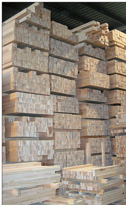
Abbildung 6 Zur Nachhärtung – sechs bis sieben Tage laut Empfehlung des Klebstoff-Herstellers – kommen die Kanteln in das Fertigwarenlager
