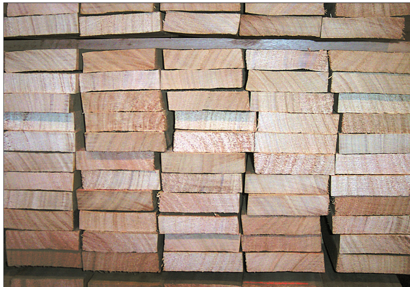
Abbildung 7 Nach der Holz Trocknung weisen die Bretter sehr unterschiedliche Querschnitte auf.
