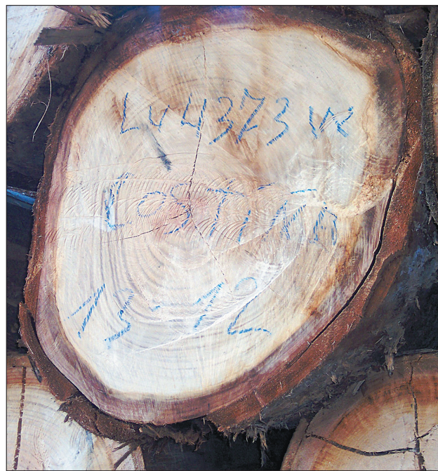
Abbildung 3 Globulus-Stämme zeigen wegen innerer Spannung häufig Ansätze für Risse
